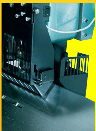
Grilles de protection et éclairage de la table.
